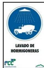
Las aguas de lavado de las **cubas de hormigón** volverán a la planta dentro de la propia cuba. Si no es así, para lavar las cubas se seguirán las indicaciones del Coordinador Medioambiental, así como para el lavado de las canaletas, cubilotes y mangas de hormigonado. Dichas aguas, de pH alto, contaminan las aguas, el suelo y pueden causar daños en depuradoras si se vierten al saneamiento público.
